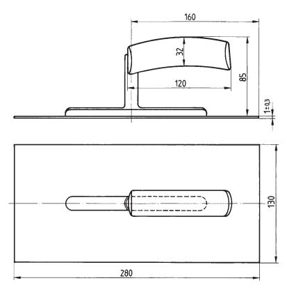
Bezeichnung einer Glättekelle aus Kaltbandstahl von 280 mm Länge:
